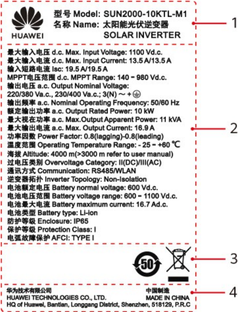
Obrázok 2-5 Výrobný štítok (na príklade SUN2000-10KTL-M1)
