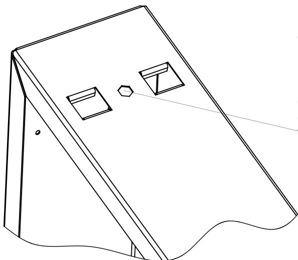
Istnieje możliwość montażu za pomocą standardowych klem i nakrętek lub przy wykorzystaniu nitonakrętki sześciokątnej M8
