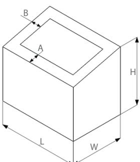
Wskazanie stref zwiększych sił ssawnych wiatru określa się na podstawie podstawowych wymiarów budynku (rys.1), gdzie:
